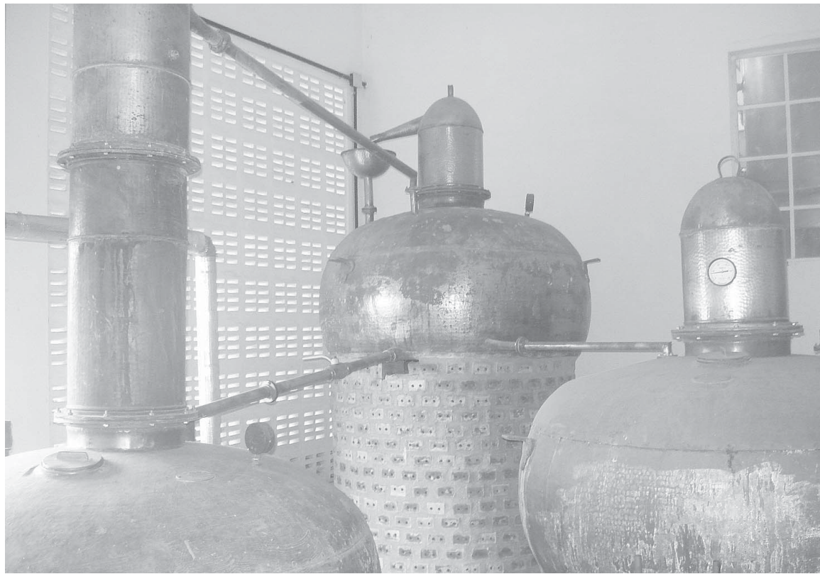
Alambiques de uma unidade de produção experimental onde vão ser desenvolvidas as atividades da Coodecana
