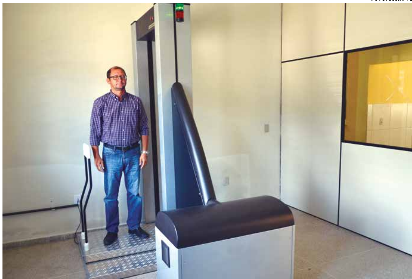
O 'body scanner' funciona através da emissão de raio-X, e permite ver tudo que o visitante conduz à instituição
