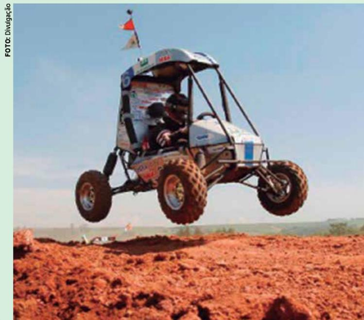
**Veículos são protótipos de estrutura tubular em aço com quatro ou mais rodas**
