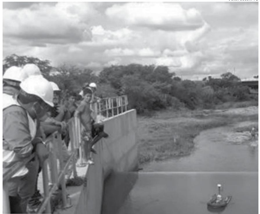
Técnicos da Aesa obtêm dados mais precisos sobre a vazão das águas através das leituras feitas pelo ADCP
