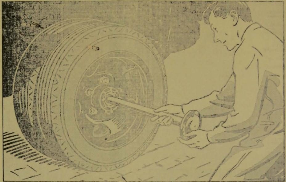
O eixo trazeiro inteiramente fluctuante é o melhor que se conhece para caminhão. Com este typo de eixo todo o peso da carga incide sobre a capa do eixo, ficando este completamente livre para exercer a sua verdadeira função — a de transmittir a força do motor ás rodas.
