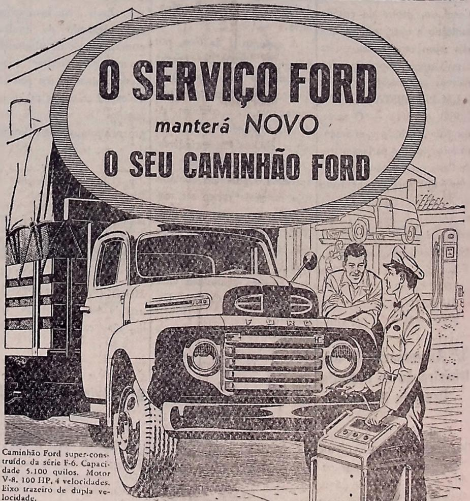
Caminhão Ford super-construído da série F-6. Capacidade 5.100 quilos. Motor V-8, 100 HP, 4 velocidades. Eixo trazeiro de dupla velocidade.
