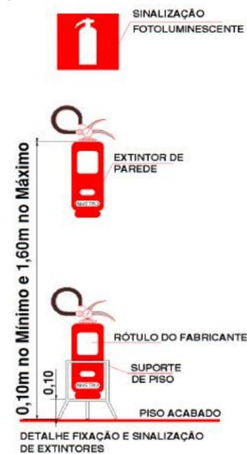
Figura 1 – Fixação do extintor
