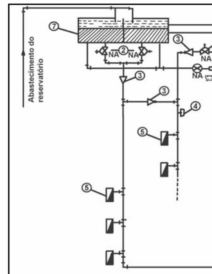
Figura C.6: Esquema de instalação de bomba de reforço abastecendo os pontos de hidrantes ou mangotinhos mais desfavoráveis considerados no cálculo, (prumada específica)
