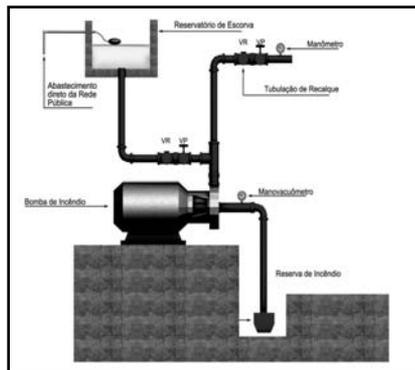
Figura C.3: Exemplo de afogamento de bomba de incêndio
