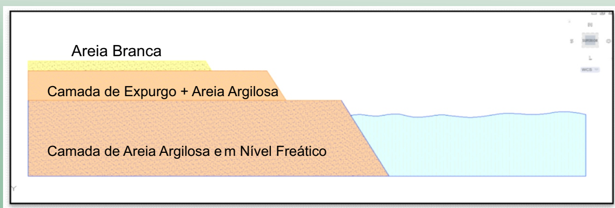
Disposição das camadas de areia por método de extração – Fonte: Companhia de Vidros Planos – CBVP.
