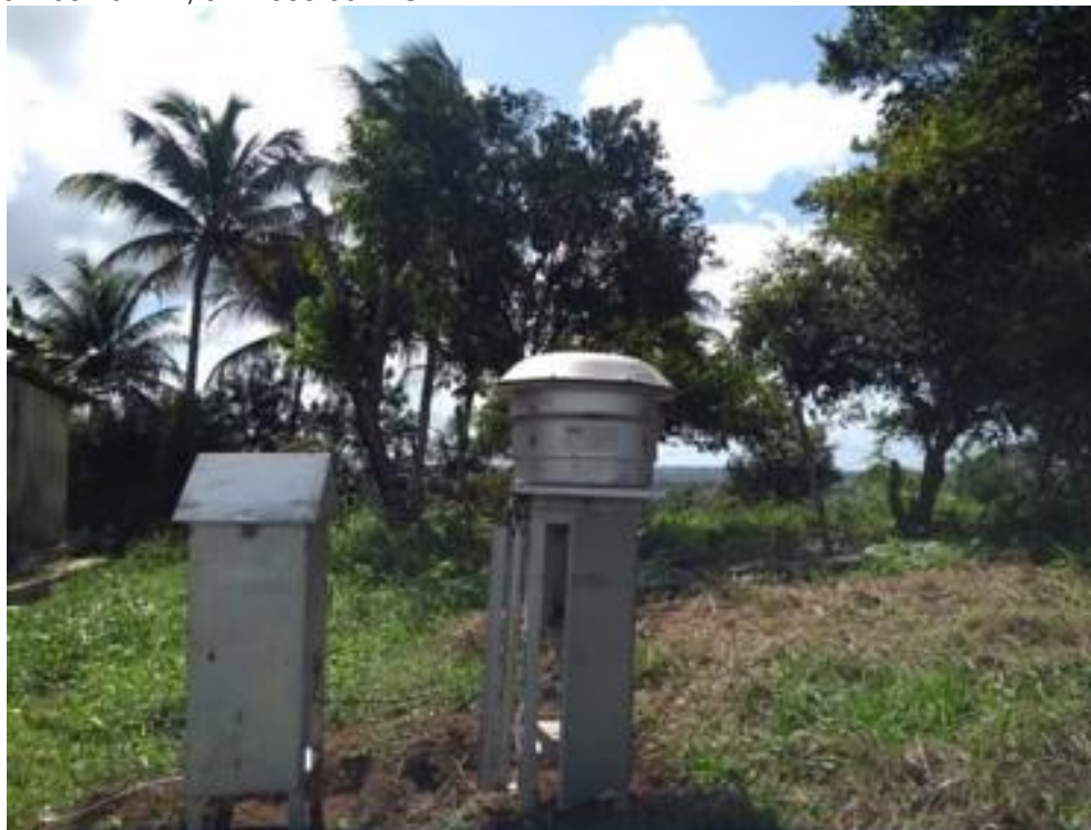
Figura 73: Amostradores de qualidade do ar no ponto de coleta 01 (QAR01), localizado na casa do Sr. Manassés, no município de Alhandra – PB. Coordenada geográfica do ponto de coleta QAR01: Zona – 25 M, 291168.20 m E, 9177588.00 m S.
