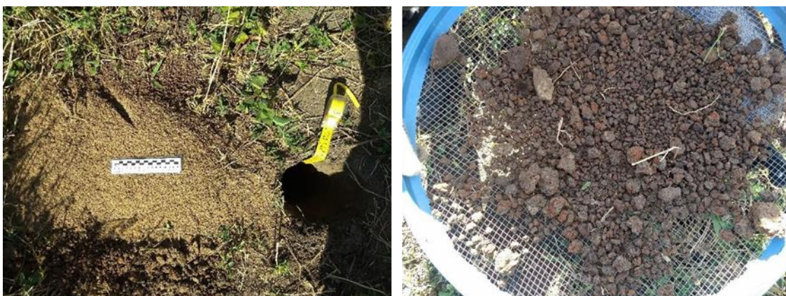
Figura 63: PT27 com sedimento argilo-arenoso de alta compactação com presença de laterita, coloração 10R 4/3.
