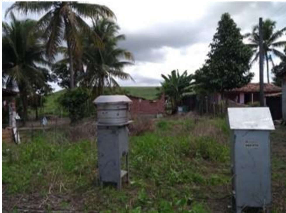
Figura 75: Amostradores de qualidade do ar no ponto de coleta 03 (QAR03), localizado na casa do Sr. Severino, no município de Pitimbu – PB. Coordenada geográfica do ponto de coleta QAR03: Zona – 25 M, 295556.30 m E, 9170656.10 m S.
