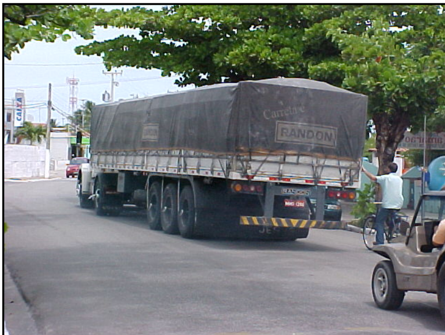
FOTO 03 – Nas vias estreitas de Cabedelo, com estacionamento lateral, o tráfego portuário por vezes tem que ocupar a faixa de rolamento contrária, no centro da via. Para dar maior mobilidade ao tráfego o deveria ser coibido o estacionamento lateral.
