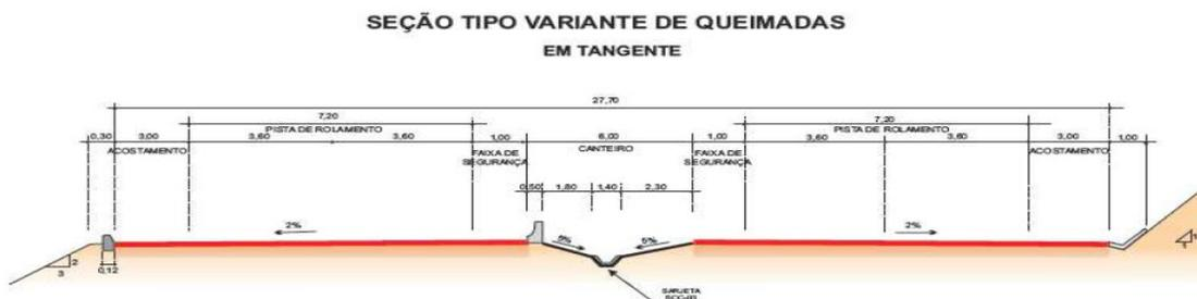
Figura 3.2.e: Seção esquemática - Variante Queimadas (em tangente)
