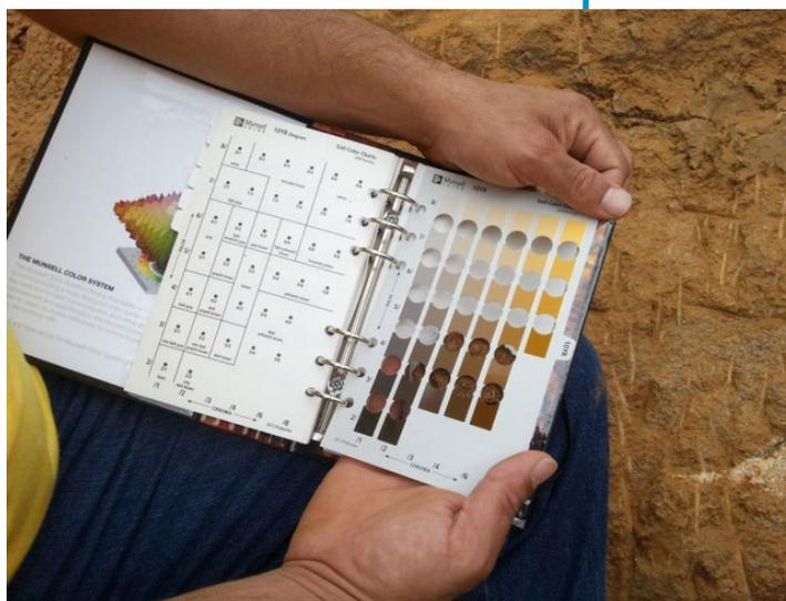
Figura 5.1.k: Detalhe da determinação da cor do solo em campo.
