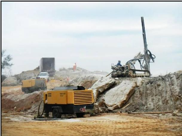
**FOTO 4.1.1** – Perfuratriz pneumática com compressor pneumático utilizada na Unidade Seropédica - RJ da VOTORANTIM CIMENTOS e semelhante a que será utilizada na Unidade Caaporã.
