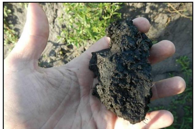
**FOTO 5.1.4** – Amostra de solo orgânico turfoso caracterizado com sendo Gleissolo Tiomórfico
