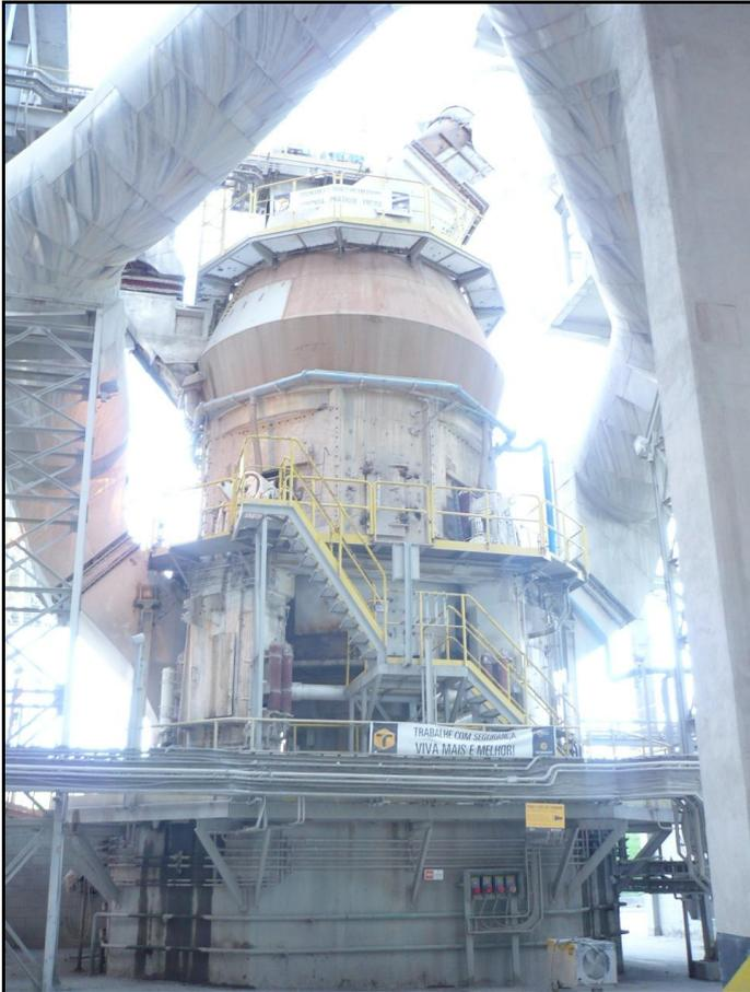
**FOTO 4.2.2.1** – Vista do moinho de cru vertical de rolos utilizado na fábrica de cimento da Unidade Laranjeiras – SE da VOTORANTIM CIMENTOS semelhante ao que será utilizado na fábrica de cimento de Caaporã.
