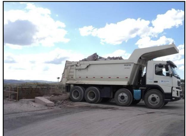
**FOTO 4.1.4** – Caminhão basculante rodoviário 8x4 da Unidade Sobradinho – DF da VOTORANTIM CIMENTOS semelhante ao que será utilizado na Unidade Caaporã
