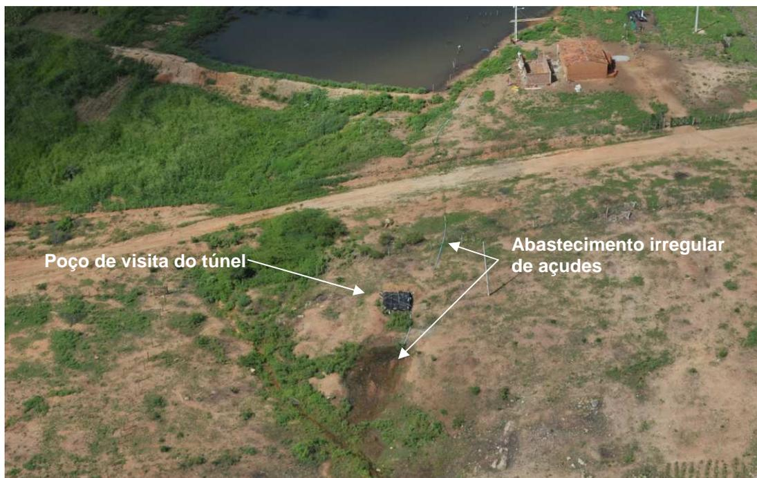
Foto 24 – Poço de Visita do túnel servindo de ponto de acesso para desvio irregular de água para abastecer açudes – Foto aérea
