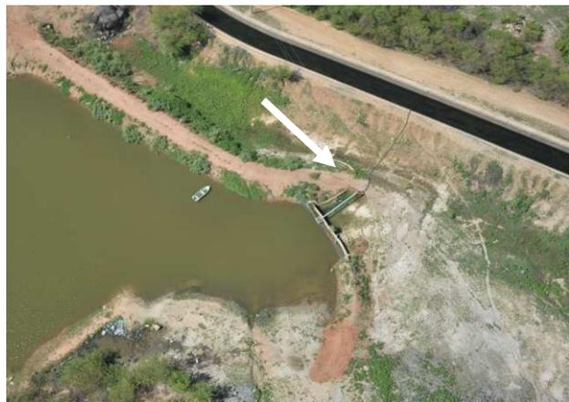
Foto 19 – Detalhe da retirada de água através de sifão instalado diretamente no canal
