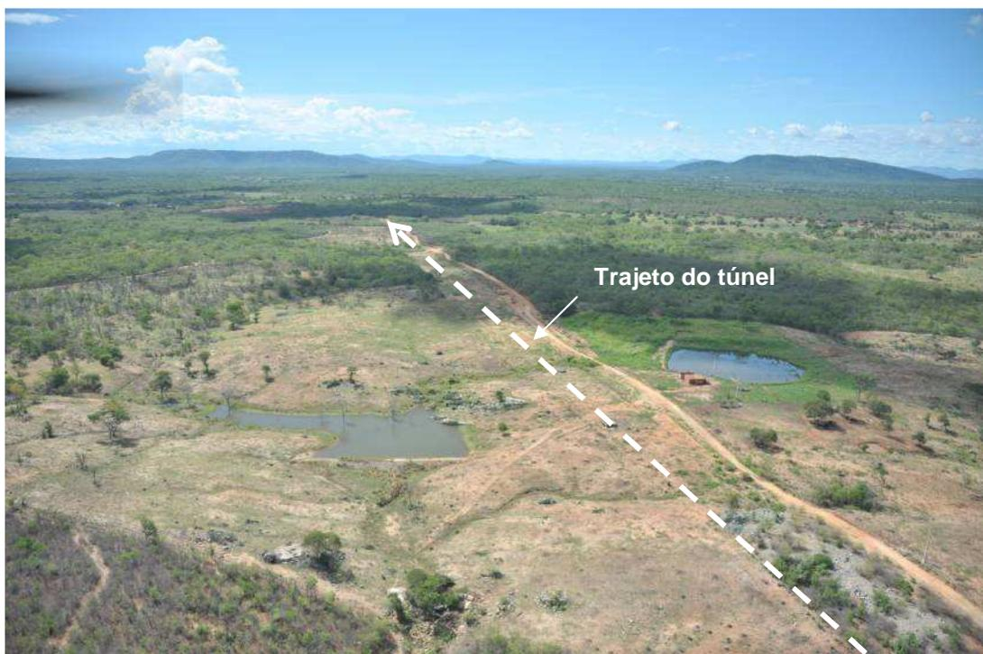
Foto 23 – Açudes sobre o túnel (seção subterrânea do canal adutor), possibilitando a infiltração e desmoronamento no interior do mesmo – Foto aérea
